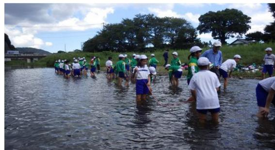
親水公園実習地では、写真のように、川に入って流速を計測します。気象条件によって水量などは変化しますので、事前確認を行ってください。
