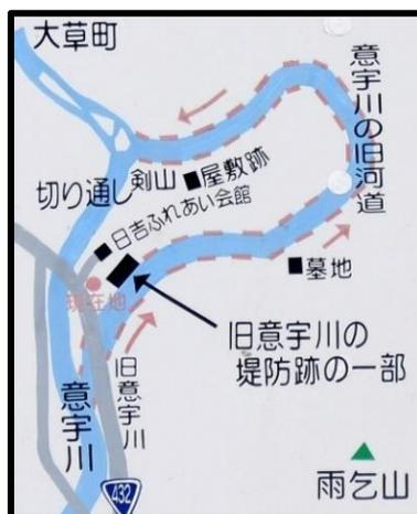
日吉の切り通しは、意宇川の氾濫を防ぐため、約 1400 万年前のデイサイト溶岩からなる細尾根を幅 30m・高さ 20m にわたって開削し、蛇行河道を短絡したものです。開削部位は滝となり、また、切り通しの開削により放棄された旧蛇行河道の地形が約 1.7km にわたって残っています。
