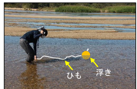
浮きを流して水の流れの速さを調べる方法
