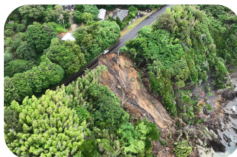
(出雲市) 令和6年の雨による路面崩落 出典：島根ドローンサービスセンター
